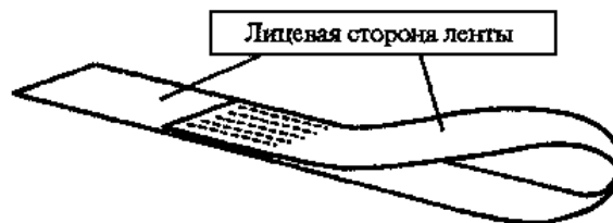
Рис. 6. Скрученная петля стропа
