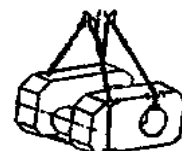
Схема строповки детали прессы
