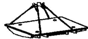
Схема строповки рамы тележки
