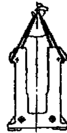
Схема строповки станины
